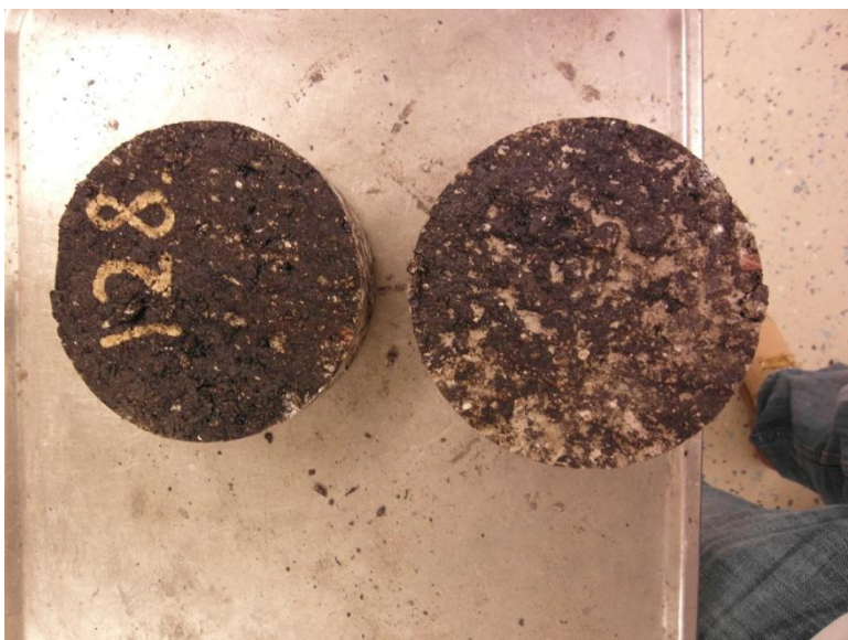
Figur 3-8 En typisk provkropp från den oklustrade ytan som genomgått ett skjuvtest. Den maximala skjuvspänningen i den här provkroppen uppgick till 0,40 Mpa. (Foto: Fredrik Elesand 2011)
