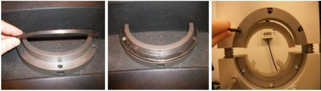
Figur 2-2 Montering av distansring på 5 mm i tjocklek, som placerades innanför den övre skjuvringen. Detta för att få en avståndsmarginal mellan skjuvringarna, och på så vis minimeras risken att gränssnittet i provkroppen delvis hamnar under en av skjuvringarna. (Foto: Fredrik Elesand 2011)
