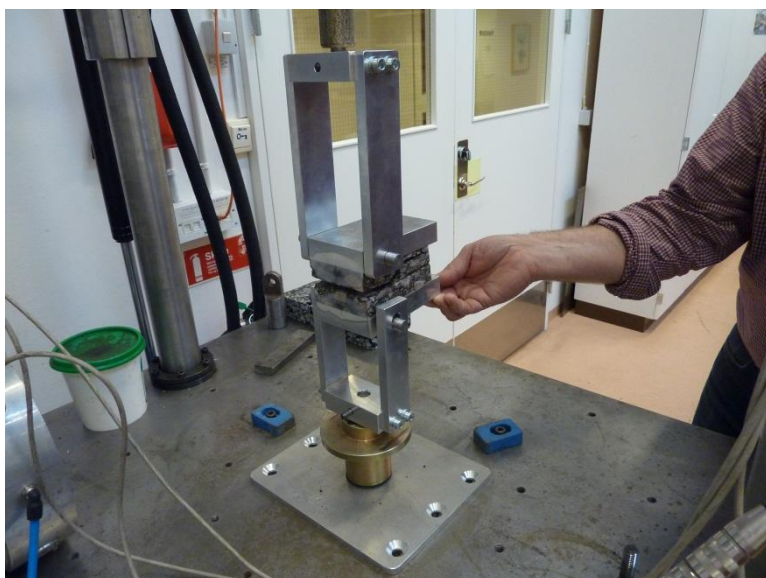
Figur 7-3 På VTI tillverkades en prototyp enligt den amerikanska metod (ASTM D7313) som beskrivs i figur 7-2 (Foto: VTI 2012).
