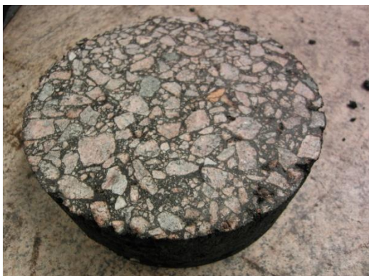
Figur 5-1 Till den andra testomgången i Kärra tillverkades provkroppar med samma typ av asfaltmassa som i den första (ABT16 70/100). Skillnaden var att den här gången utfördes klistringen på sågade ytor, varvid asfaltmassa packades gyratoriskt ovanpå detta. (Foto: Fredrik Elesand 2012)
