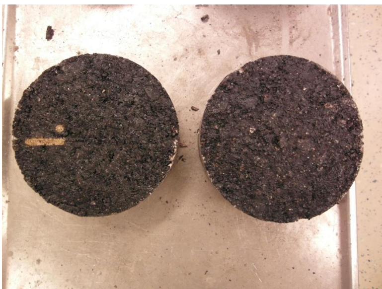
Figur 3-9 Typexempel på en provkropp från den sektion som klustrades flödigt efter utfört skjuvtest. Den maximala skjuvspänningen i den här provkroppen uppgick till 0,57 Mpa. (Foto: Fredrik Elesand 2011)
