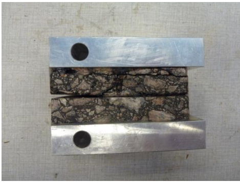
Figur 7-4 En 150 mm provkropp sågas till med dimensionerna 130x85x38 mm, med ett snitt som går 50 mm in i provkroppen. Därefter limmas plattor på provkroppen som behövs för att montera provkroppen i testriggen. (Foto: VTI 2012)
