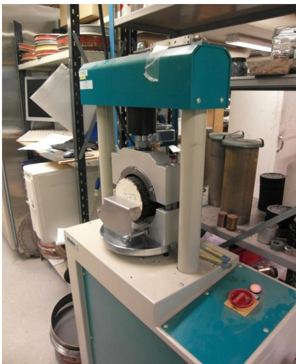
Figur 4-3 Leutnerapparaten monterad med en provkropp i den testmaskin som användes vid NCCs laboratorium i Göteborg. (Foto: Fredrik Elesand 2011)
