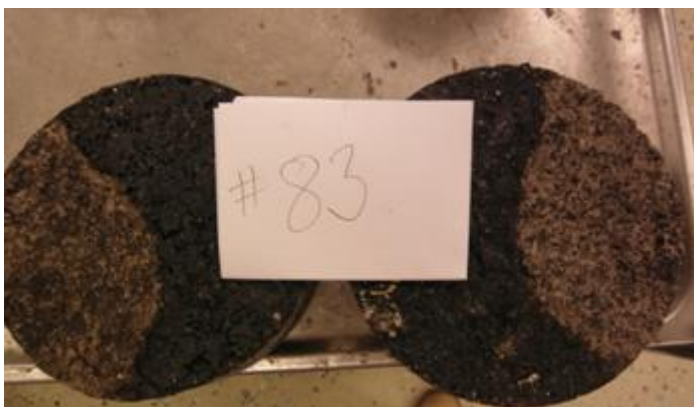
Figur 3-10 En av provkropparna som togs upp från den sparsamt klistrade ytan. Täckningsgraden blev långt ifrån 100 %, vilket tydligt framgår här. Dock var den maximala skjuvspänningen normal i förhållande till provkropparna som testades i den här studien. 0,47 Mpa, som kan jämföras med de värden som presenteras i Tabell 3-1.
