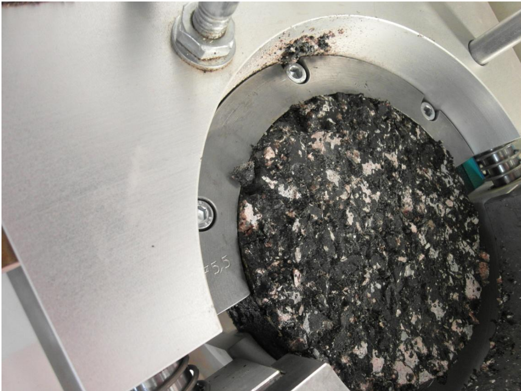
Figur 5-3 En av de provkroppar utan klister som skjuvtestades i Kärra. På bilden syns det undre sågade lagret i provkroppen, och delar av asfaltmassa som är kvar från det övre lagret efter utförd skjuvtest. Just den här provkroppen uppvisade näst högst skjuvspänning av alla provkroppar som testades i den här studien, 2,42 Mpa. (Foto: Fredrik Elesand 2012)
