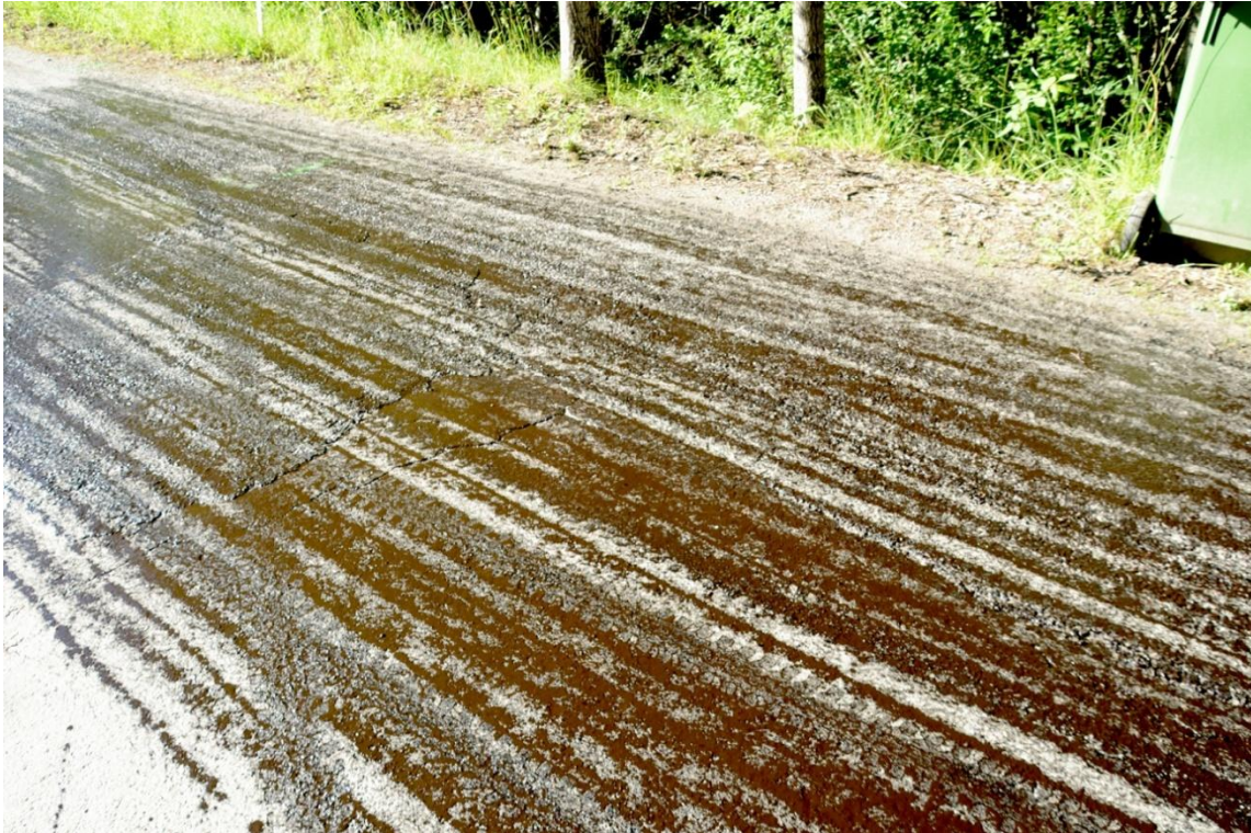
Figur 3-2 Ytan som klustrades sparsamt, med en ungefärlig täckningsgrad på 50 %. (Foto: Tomas Åström, 2011)
