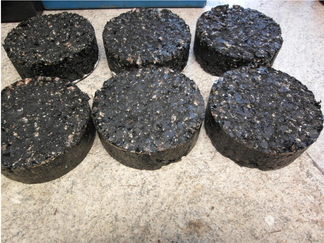
Figur 5-2 Provkropparna som klustrades med produkten "x". Här upplagda efter utförda skjuvtester. (Foto: Fredrik Elesand 2012)
