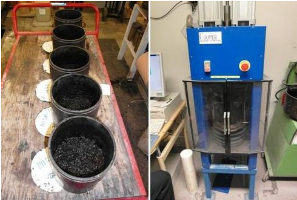
Figur 4-1 Bilden till vänster visar fem provkroppar där ett lager ABT16 packats gyrotoriskt, och där ett lager klister applicerats. Efter att emulsionen fått bryta packades ännu ett lager ABT16 på detta. Bilden till höger visar den gyrotoriska kompaktorn som användes vid tillverkningen av provkropparna i Kärra. (Foto: Fredrik Elesand 2011)
