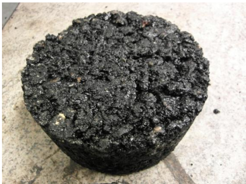
Figur 4-2 provkropparna som klistrades i den här testomgången hade en förhållandevis skrovlig gränssnittsytta. (Foto: Fredrik Elesand 2011)
