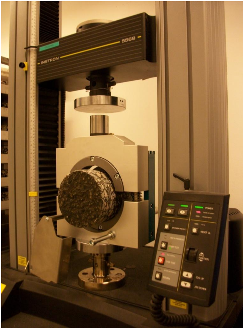
Figur 2-4 Skjuvanordningen monterad med en provkropp i testmaskinen, och klar för provning. (Foto: Fredrik Elesand 2011)
