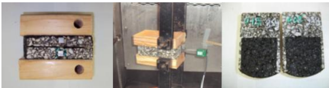
Figur 7-2 Fracture energy based interface bond test (IBT), är en typ av dragtest som testades vid VTI. På bilden syns en preparerad provkropp före, under och efter utförd testning. Det framgick tidigt i provningen att metoden, och provberedningen får anses vara besvärlig och opraktisk (Hakimzadeh m.fl. 2011).
